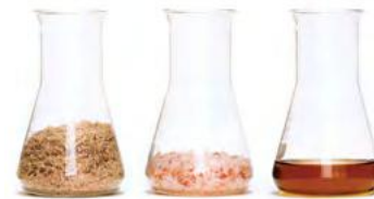
ca. 60% Reishülsen + ca. 22% Steinsalz + ca. 18% Mineralöl = Resysta
